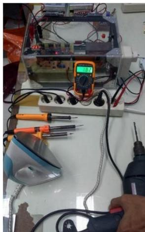
Gambar 9. Pengujian Inverter dalam keadaan berbeban
